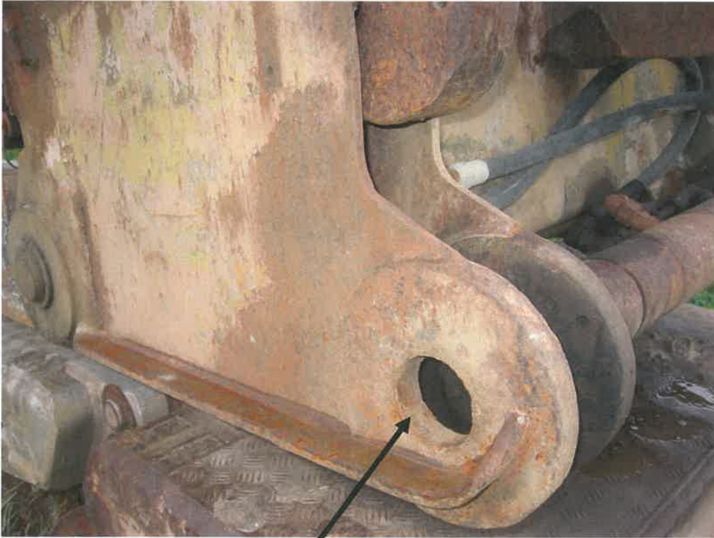
Bolzenauge zweischnittig t = 31\text{mm}
