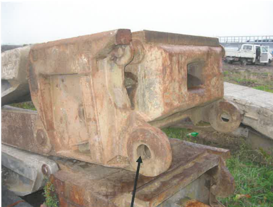
Bolzenauge zweischnittig t = 63\text{mm}
